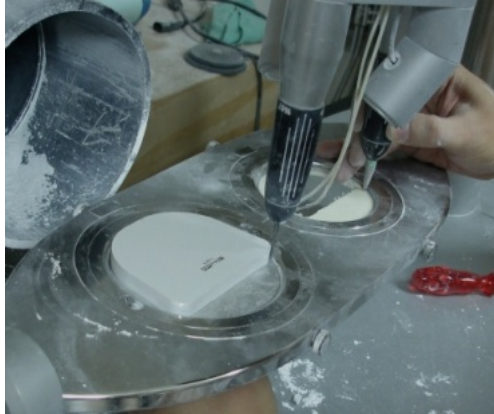
Fig. 28. Se verifica que el bloque de zirconia abarque los patrones de resina colocadas en el disco.
