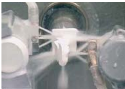
Fig.60 Dos fresas unidas al torno trabajan paralelas y simultáneamente, con refrigeración abundante [29]
