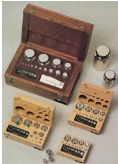
Figura 1.11. Juegos de pesas de diferentes clases de exactitud.
