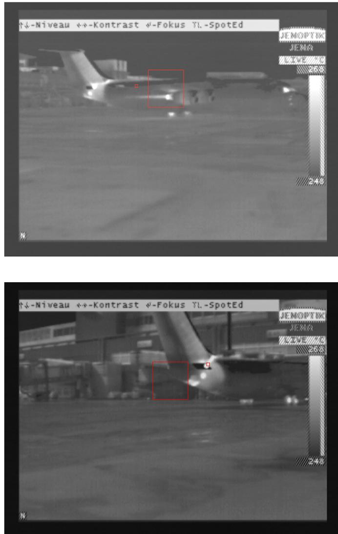
Figura 5.13. a) Imagen infrarrojas antes del procedimiento FTS del APU tipo APS 3200. b) Imagen infrarrojas posterior al procedimiento FTS de medición del APU.
