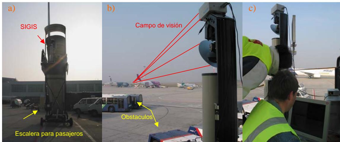
Figura 5.15 a) Escalera utilizada durante las mediciones en el aeropuerto internacional de la ciudad de Budapest Hungría. b) Nuevo campo de visión del instrumento sobre la escalera. c) Imagen durante la medición.
