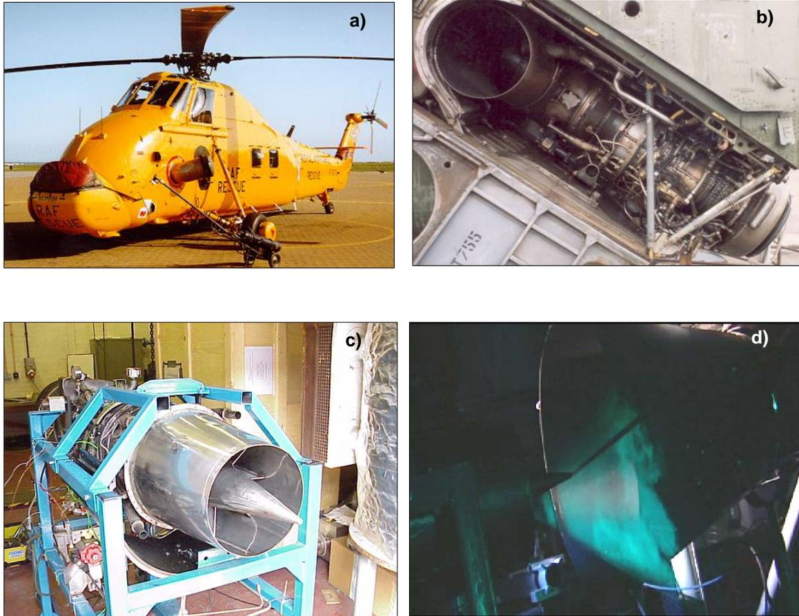
*Figura 6.1. a) Helicóptero Westland Wessex b) Motor de propulsión Gnome 1200 desarrollado por la compañía Rolls-Royce c) Motor Gnome 1200 modificado para su instalación en una cama de pruebas d) Motor Gnome 1200 en operación.*
