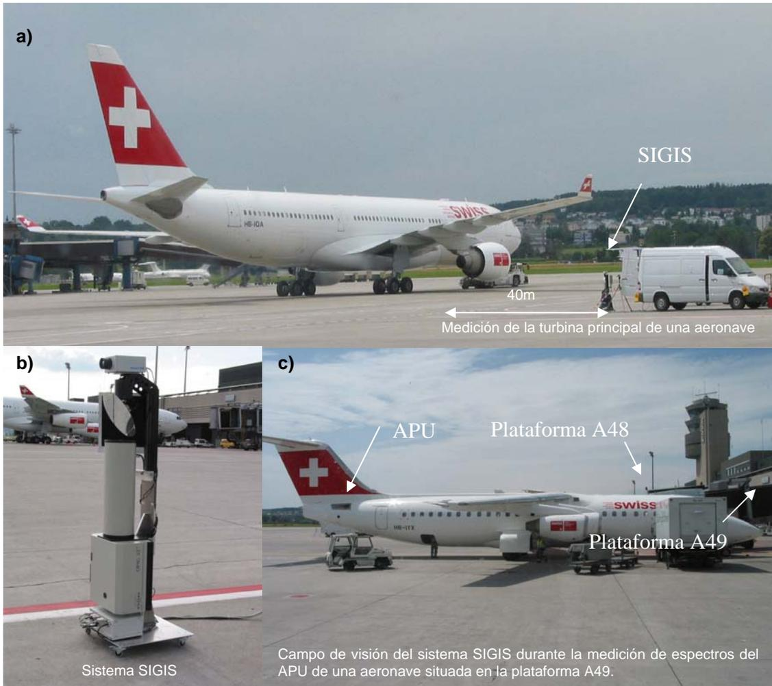
Figura 5.4 a) Imagen en donde se muestra la posición de medición del sistema SIGIS para los motores de las aeronaves. b) sistema SIGIS durante la medición c) Campo de visión para la medición de las emisiones del APU durante la estadia de las aeronaves en plataforma.
