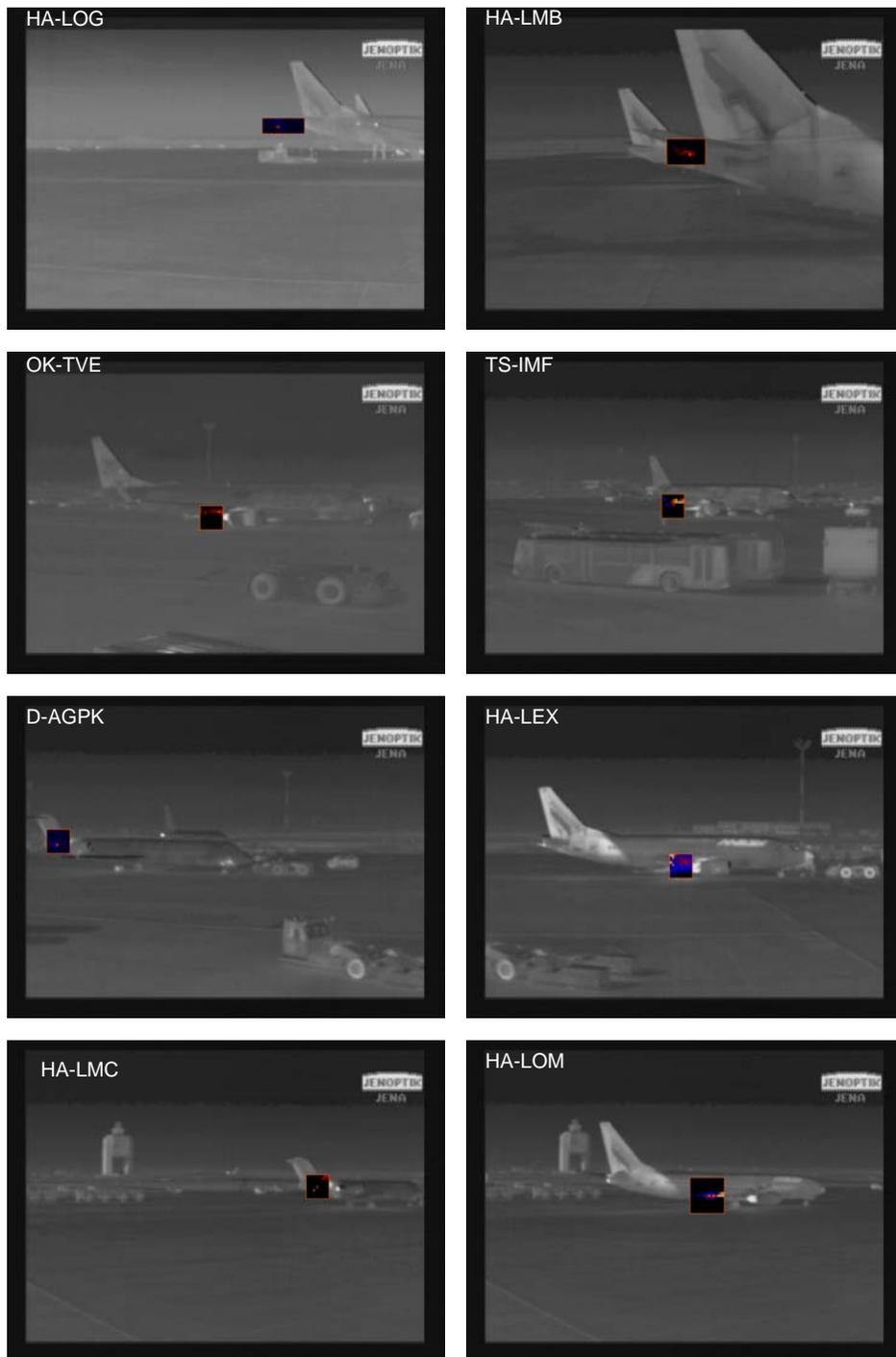
Figura 5.16 Termo imágenes capturadas durante la medición de espectros a alta resolución de las aeronaves McDonnell Douglas MD-11 (HA-LOG), Boeing 737-7Q8 (HA-LOP), Boeing 737-86Q (OK-TVE), Airbus A320-211 (TS-IMF), Fokker 100 (D-AGPK), Boeing 737-3Y0 (HA-LEX), Fokker 70 (HA-LMB), Fokker 70 (HA-LMC), Boeing 737-8Q8 (HA-LOM).
