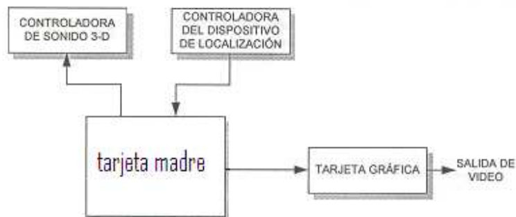
fig. III.10 Un ejemplo de arquitectura de hardware 28
