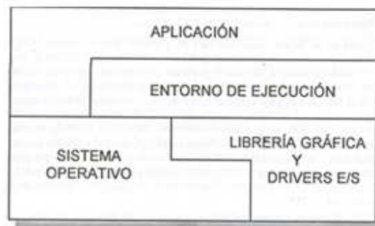
fig. III.II Arquitectura de software de una computadora 30
