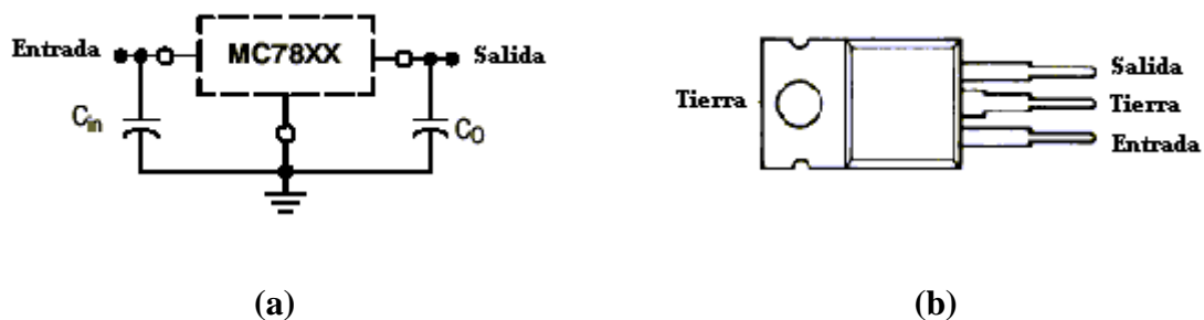
Figura 2.22 a) Conexión típica de un regulador de voltaje MC78XX. b) Encapsulado TO-220 de un regulador de voltaje MC78XX.
