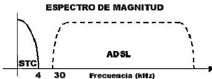
Figura 2.10 Utilización del espectro de frecuencia en el par trenzado para el servicio telefónico convencional (STC) y para el de transmisión de datos a alta velocidad (ADSL).[11]
