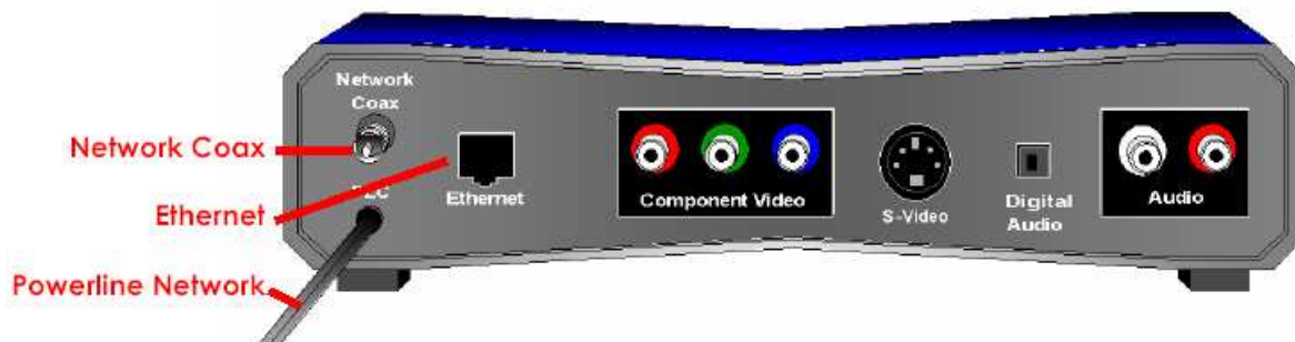
Figura 2.9 STB híbrido. PLC/Coax/Ethernet [9]
