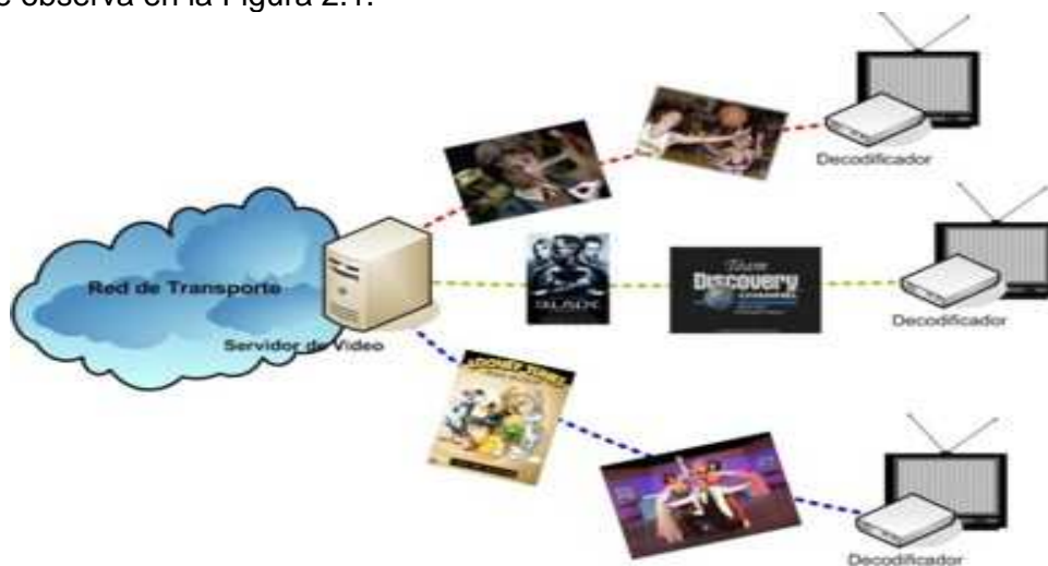
Figura 2.1 Esquema de distribución de programación con IPTV
