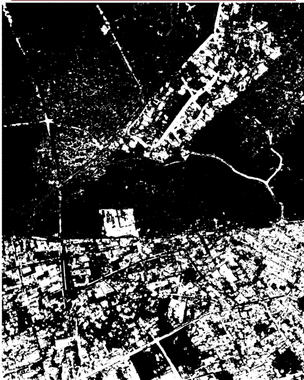
FIGURA 7.1.4. Resultado de aplicar el esquema de decisión probabilística a DFb.jpg con dos clases (urbana y no urbana) con probabilidades p_{w_1} =
