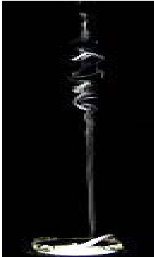
Figura 4.61. Flujo laminar y transición a la turbulencia en el humo que se desprende de un cigarrillo.
