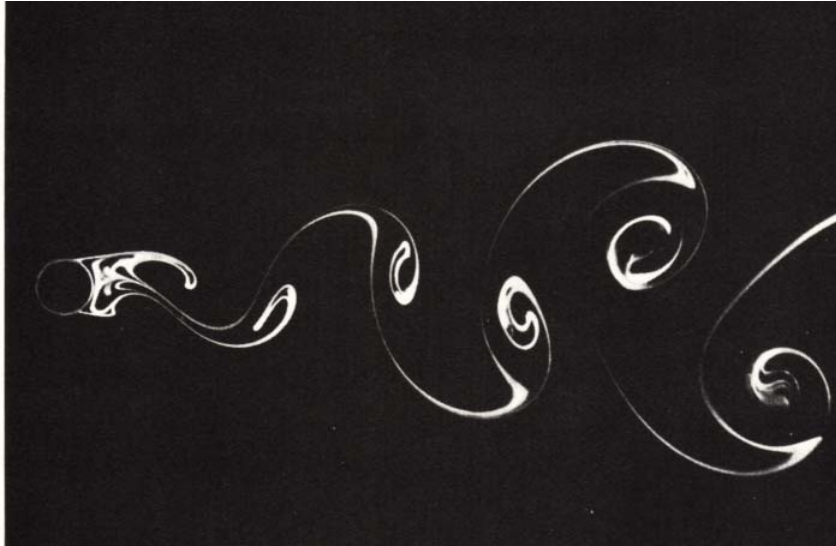
Figura 2.11. Calle de vórtices de Von Kármán. Tomada de Gerhart, Gross y Hochstein (1995).
