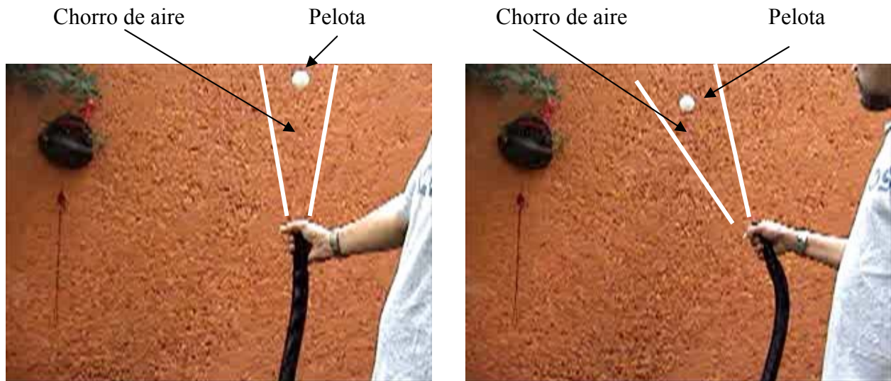
Figura 2.9. Pelota de ping pong suspendida en un chorro de aire producido por una aspiradora.
