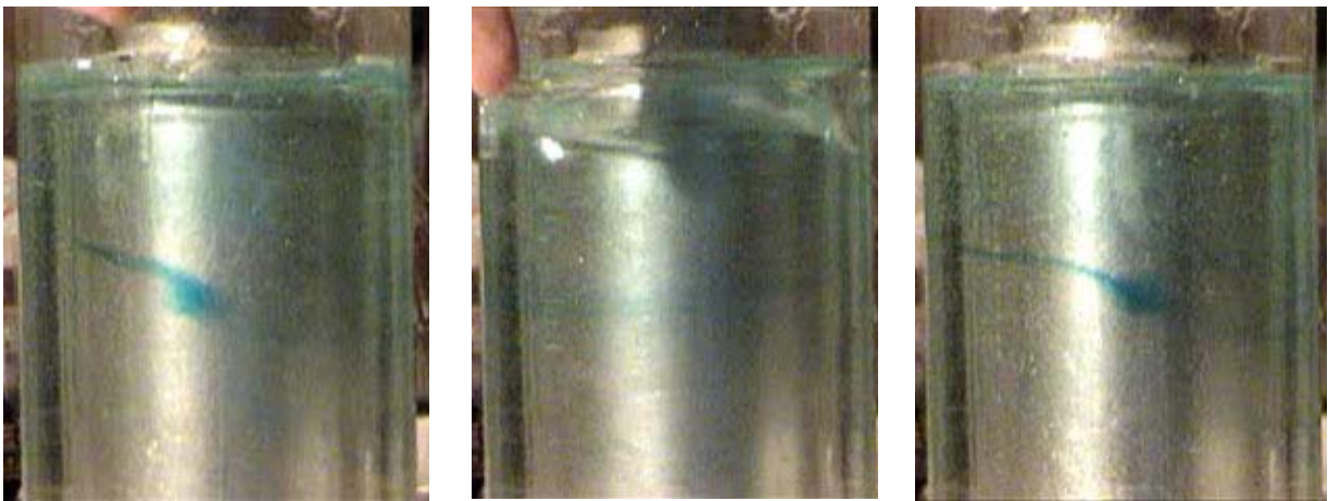
Figura 4.71. En las fotografías se muestra una gota colocada entre dos cilindros que rotan en tres instantes distintos, al inicio, uno intermedio y al final del movimiento. El número de Reynolds es de alrededor de 5.
