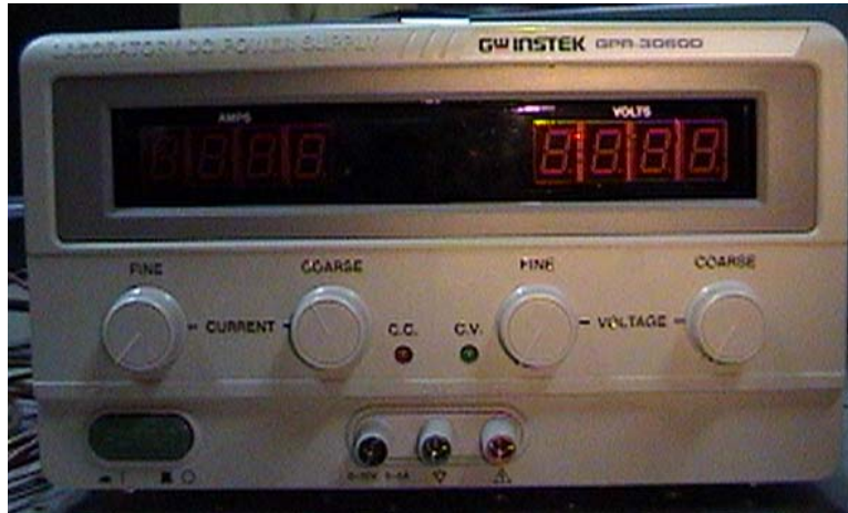
Figura 4.31. Fuente de voltaje de corriente continua.
