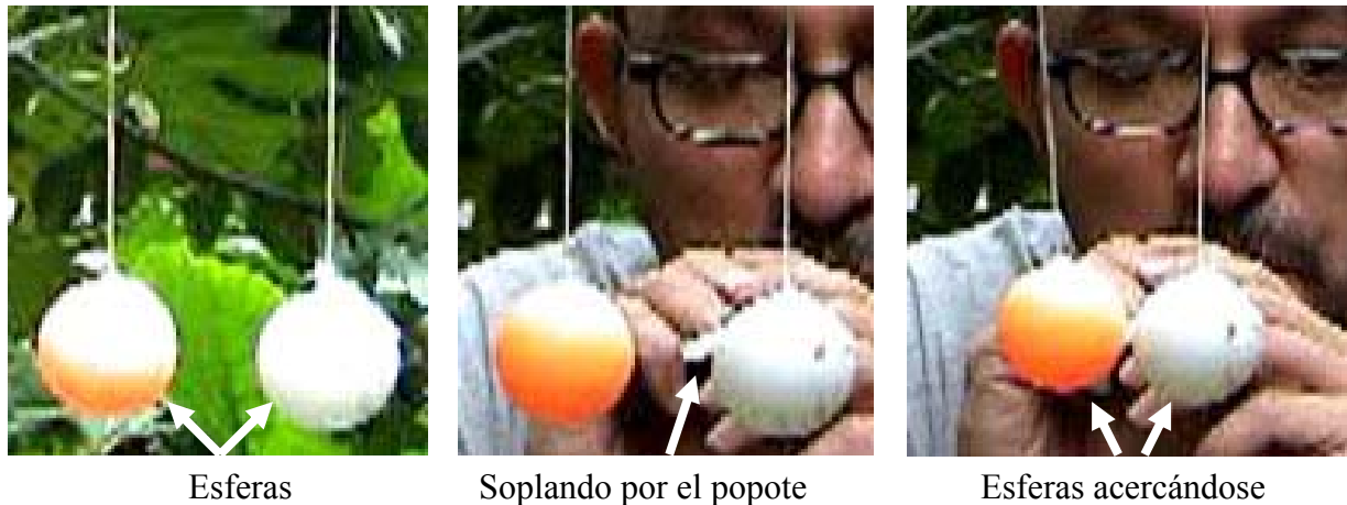
Figura 2.10. Esferas que se mueven una hacia otra cuando se sopla entre ambas, por medio de un popote.
