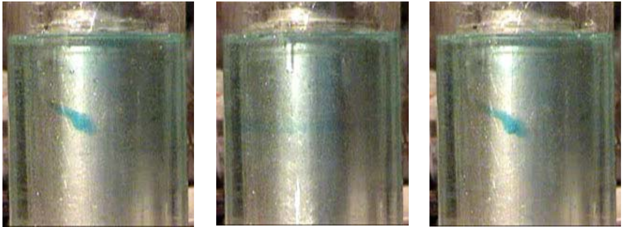
Figura 4.70. En las fotografías se muestra una gota colocada entre dos cilindros que rotan en tres instantes distintos, al inicio, uno intermedio y al final del movimiento. El número de Reynolds es de alrededor de 0.5.
