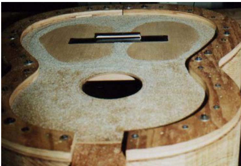
Figura 4.13: Segundo modo de vibración de la tapa sin diapasón, frecuencia de 225 Hz.
