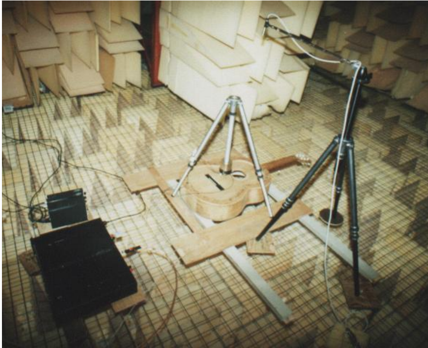
Figura 4.3: Arreglo experimental dentro de la cámara anecoica.
