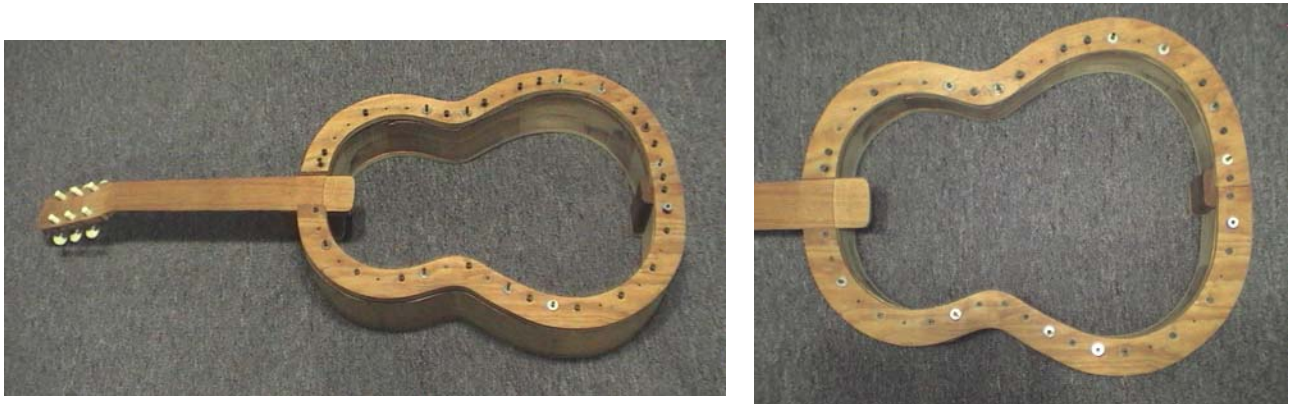
Figura 4.1: Sistema de costillas rígidas sin fondo para soportar la tapa.
