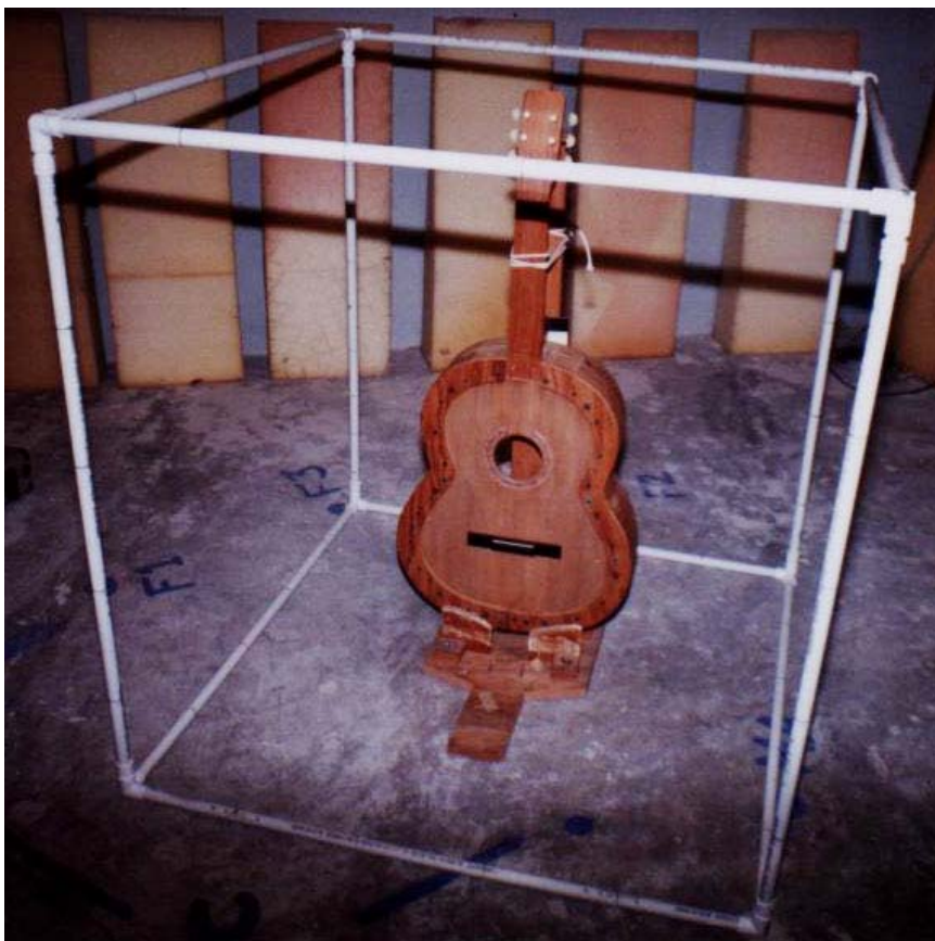
Figura 5.2: Arreglo para delimitar el área de medición de la potencia acústica.
