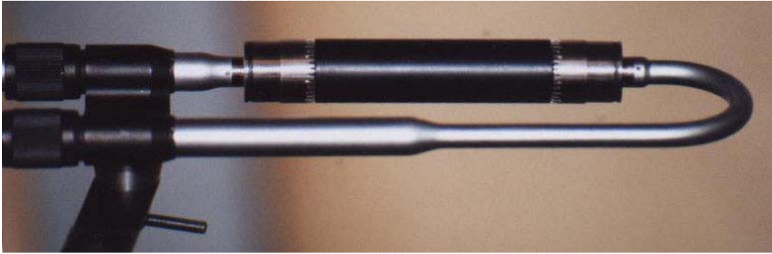
Figura 5.1: Micrófonos de la sonda de intensidad con espaciador UC5270 de 50 mm.
