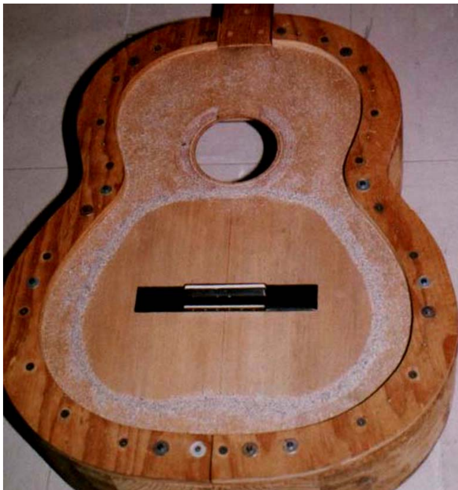
Figura 4.12: Primer modo de vibración de la tapa sin diapasón, frecuencia de 148 Hz.
