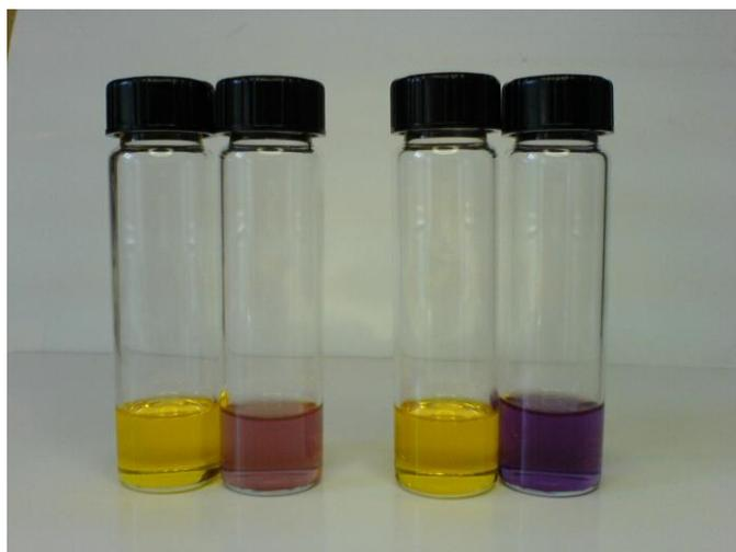
Figura 22 De izquierda a derecha, copolímero CP2 disuelto en  $\text{CHCl}_3$ , copolímero CP2 disuelto en Metanol/Cloroformo (80/20), copolímero CP1 disuelto en  $\text{CHCl}_3$ , copolímero CP1 disuelto en Metanol/Cloroformo (80/20), todas las soluciones se encuentran a temperatura ambiente.
