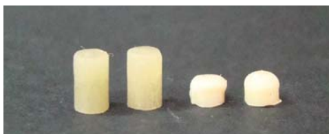
Figura 40. Comparación de la profundidad de curado de la resina MB (izquierda) y de la resina con pigmentos inorgánicos (derecha).
