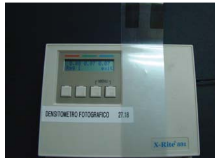
Figura 39. Medición de la densidad óptica de la imagen radiográfica de la muestra de resina y la muestra de aluminio en el densitómetro.
