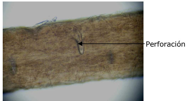
Figura 3.3 Prueba de perforación del pelo
