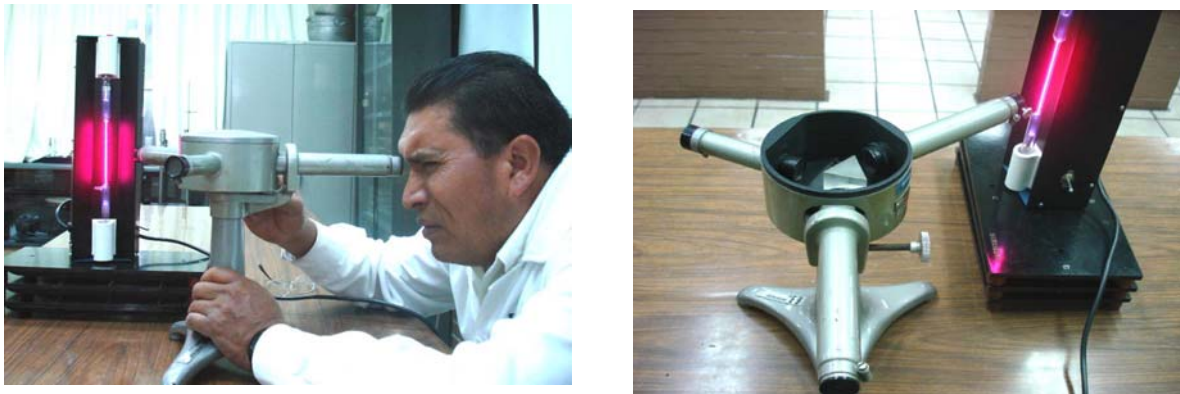
Figura A.4 Los espectrómetros son instrumentos que generan, analizan y registran espectros. Las lentes del instrumento enfocan la luz, mientras que un prisma central la divide en el espectro de los colores que la constituyen. Los colores que aparecen en la pantalla
