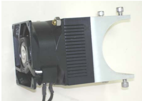
Figura 6.- Disipador de calor que se diseñó para acoplar a los tubos Apogee
