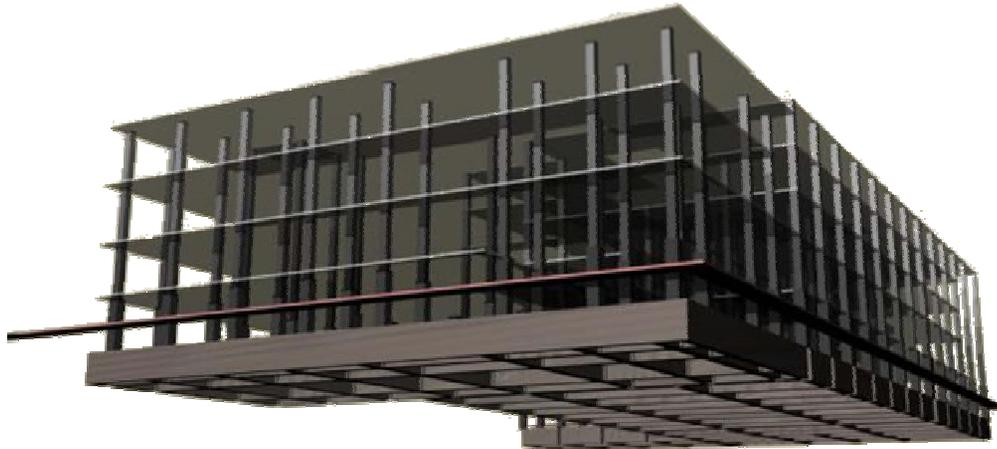
EL EDIFICIO DESCANSA SOBRE CAJONES DE CIMENTACIÓN DE CONCRETO ARMADO QUE TIENEN COMO PERALTE 2.00 MTS.
