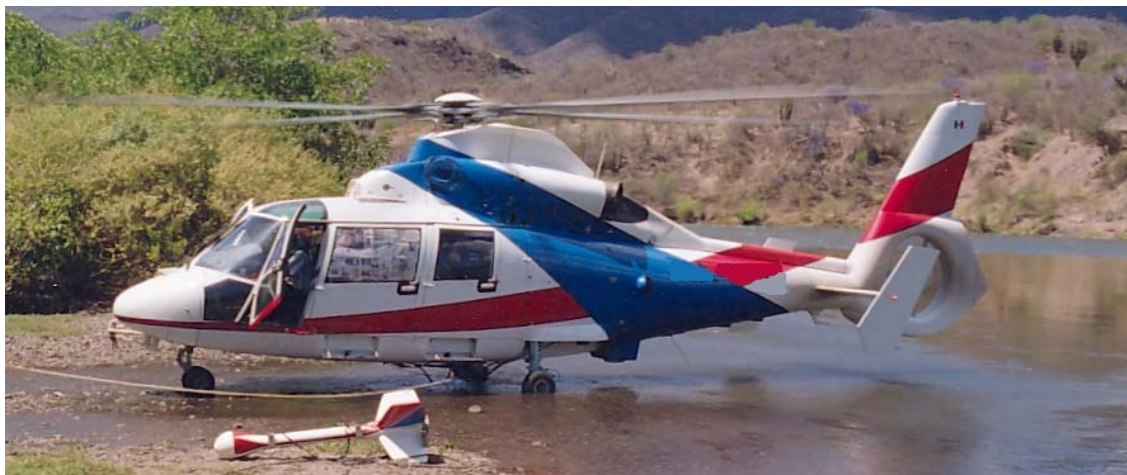
Figura 9. Helicóptero Dauphin y pájaro (Dispositivo que contiene al sensor magnético) utilizados en el levantamiento aeromagnético de Cerro Blanco.
