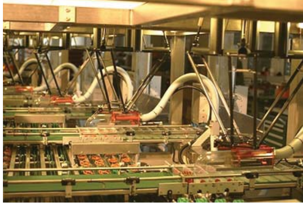
Figura 1.7: Instalación para el empaquetado de Pretzels en una industria de pan
