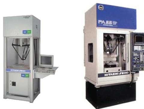
Figura 1.9: Robots Delta para operaciones de tomar y colocar y perforación
