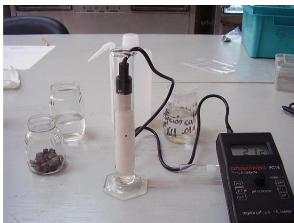
Figura 22. Prueba de conductividad eléctrica
