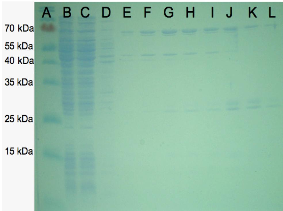
Figura 15. Electroforesis en gel de poliacrilamida de la purificación montada para la clona N14. Carriles: A) Marcador de peso molecular, B) y C) lavados, D) al L) fracciones colectadas. No es posible encontrar la banda correspondiente a la clona N14. Debería encontrarse entre los marcadores de peso molecular que indican 25 kDa y 15 kDa. Solamente se aprecia una banda que se encuentra más arriba de 25 kDa, probablemente a causa del pegado inespecífico de alguna proteína presente en el lisado.
