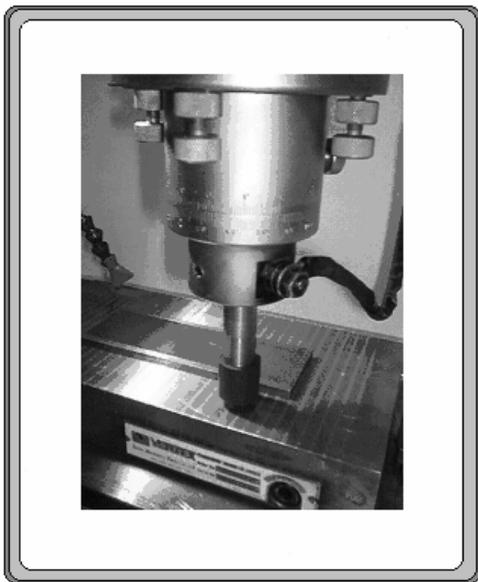
FIGURA 55. Centrado de la pieza primer punto de referencia
