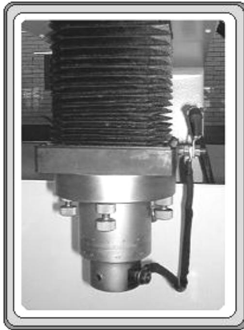
FIGURA 6. Sistema de sujeción de la máquina de Electroerosión
