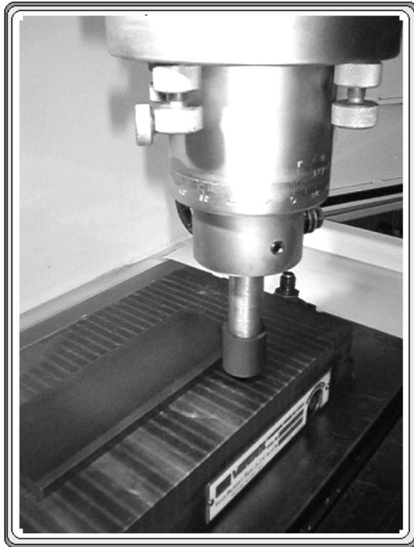
FIGURA 58. Preparación de una prueba con el electrodo de grafito.
