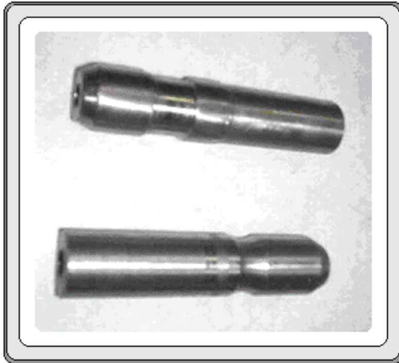
FIGURA 9a). Portaelectrodos con rosca interna de acero 1018 fabricados por CNC.
