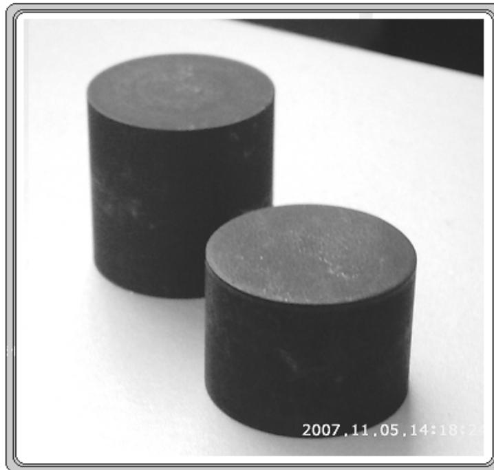
FIGURA 57. Eléctrodos cilíndricos de grafito de 1 pulgada de diámetro.
