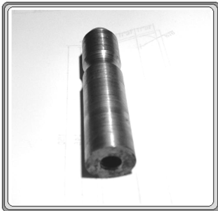
FIGURA 9b). Portaelectrodos con rosca interna de acero templado 1018.
