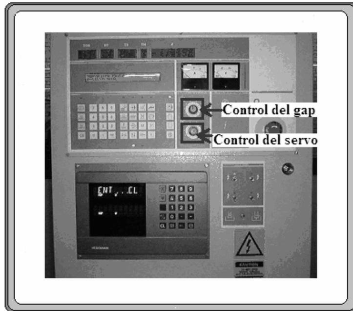
FIGURA 49. Control de regulación del Gap y regulación de la sensibilidad del servo.
