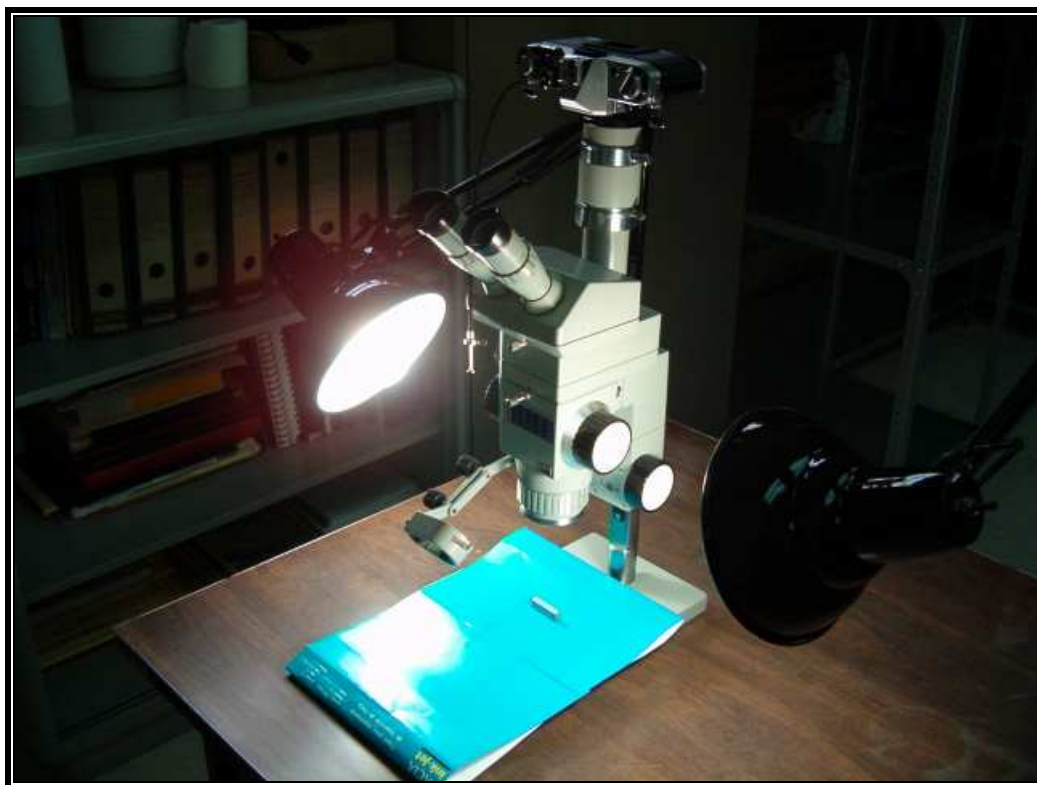
Figura 2.3.1 Montaje para la obtención de la macrografía de la sección transversal del cordón de soldadura.
