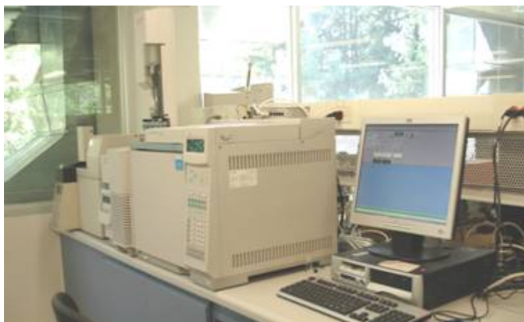
Figura 3.5. Cromatógrafo de Gases HP 6890N, acoplado a un detector selectivo de masas modelo HP 5973N.
