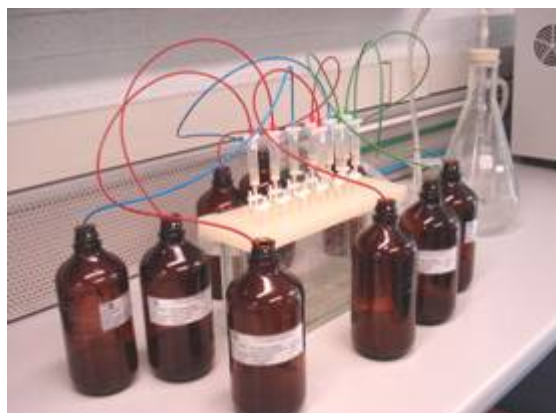
Figura 3.1. Sistema de Extracción en Fase Sólida (SPE)
