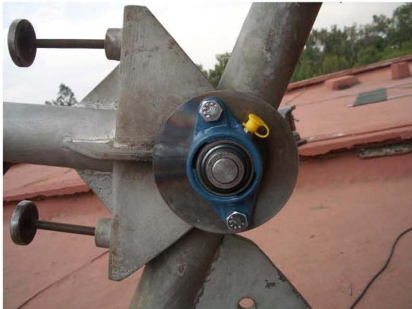
Figura 9.8: Ejes del Radiointerferómetro actualizados.
