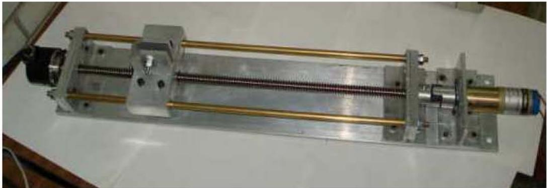
Figura 9.19: Actuador armado
