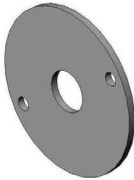
Figura 9.3: Soporte para sujetar las chumaceras.
