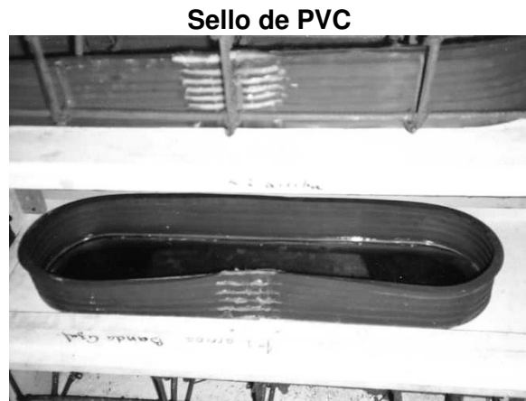
FIGURA II.36 PRUEBAS TRIDIMENSIONALES EN LOS SELLOS DE COBRE Y PVC DE AGUAMILPA
