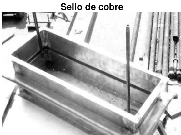
FIGURA II.36 PRUEBAS TRIDIMENSIONALES EN LOS SELLOS DE COBRE Y PVC DE AGUAMILPA
