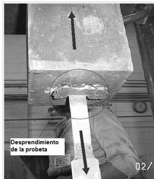
FIGURA II.37 PRUEBAS A LA PRIMERA BARRERA DEL SELLO PARA EL CAJÓN
