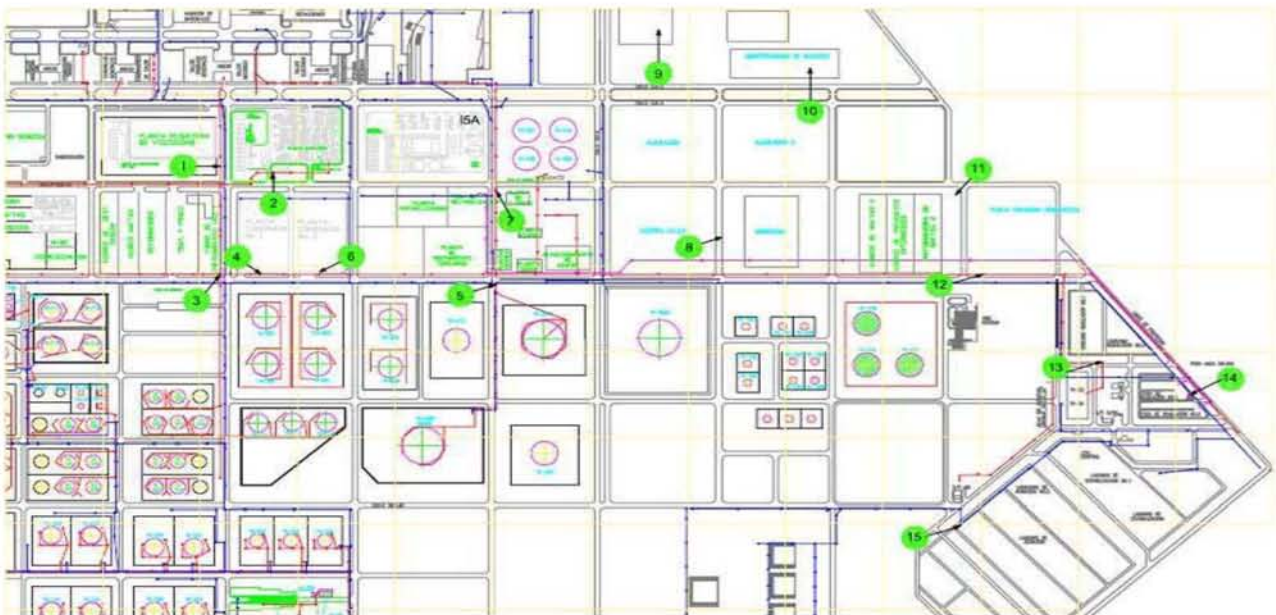
Figura 7. Puntos de muestreo típicos para una refinería, desde planta de proceso hasta el área de efluentes
