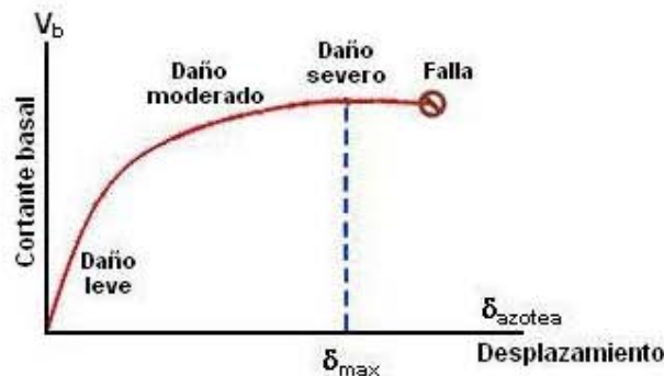
Fig. 3.3 Evaluación del nivel de daño
