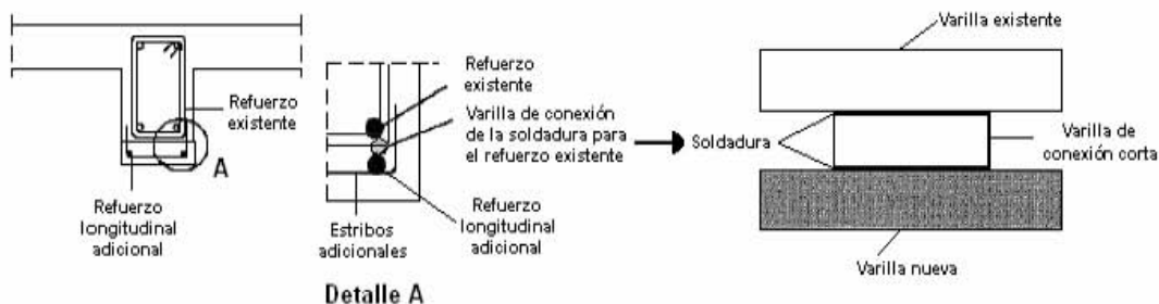
6.8 Encamisado inferior de una viga (Aguilar et al., 1996)
