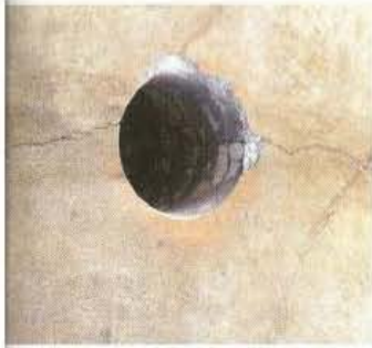
Fig. 5.27 Los núcleos de 50 mm de diámetro son útiles para los puertos maestros (Trout, 2005)
