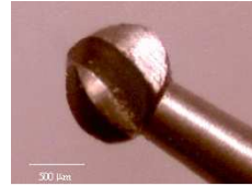
Figura 3.9: Cortador con el que se maquinaron las canaletas para las fibras ópticas.
