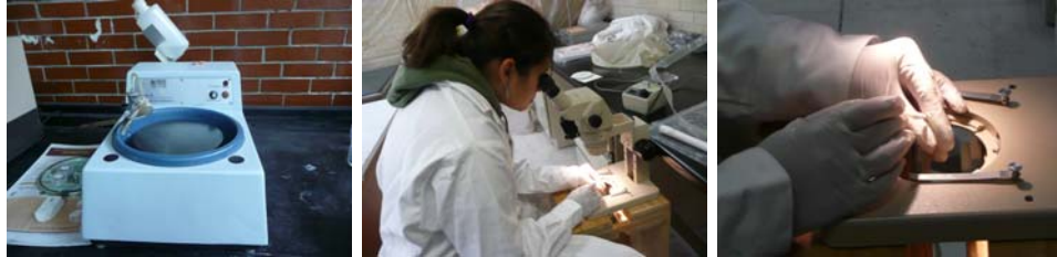
Figura 3.19: Maquina pulidora. En el microscopio se observan y se limpian todas las imperfecciones que tienen las fibras después de pulir
