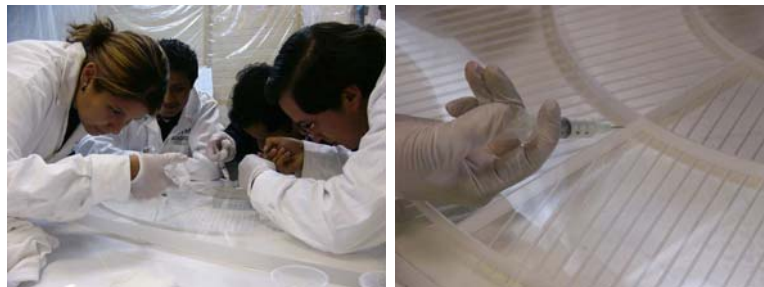
Figura 3.11: La fotografía muestra como se pegó el centellador del segundo lado, si se observa se pueden ver del lado contrario las ranuras para las fibras ya hechas.
