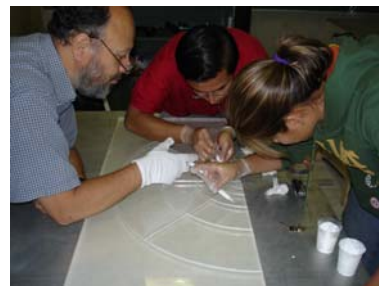
Figura 3.7: La fotografía muestra como se pegó el centellador. Se rellena las ranuras con pegamento óptico, usando guantes y jeringas para inyectar el pegamento .
