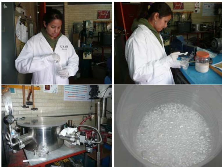
Figura 3.12: Proceso de la preparación del pegamento óptico que se utilizó para hacer la técnica de MegaTile. En la primera foto se puede observar como se mezclan las dos sustancias del pegamento. En la segunda foto se le añade el dióxido de titanio. La tercera muestra la cámara de vacío que se utilizó para sacar el aire del pegamento. Por ultimo en la cuarta se ve las burbujas en el pegamento, aire que esta tratando de salir debido a la baja presión a la que se le impuso al pegamento.
