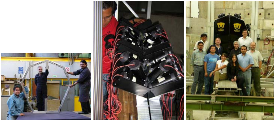
Figura 3.29: En la primera fotografía esta el soporte de aluminio para el detector V0A. En la segunda se muestran dos de las cajas de los PMTs. En la tercera el V0A terminado en el CERN Ginebra, Suiza donde se caracterizó con haz.
