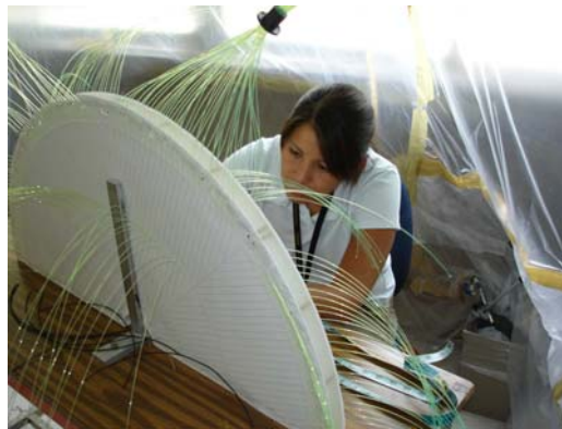
Figura 3.23: Las fibras se escogen primero según la medida de estas. Se meten en su respectivo anillo a través del forro de teflón llegando hasta el plástico centellador.
