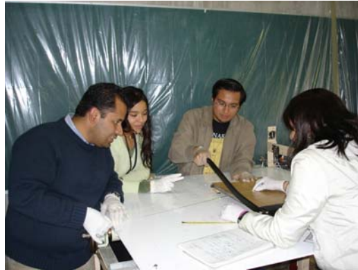
Figura 3.17: Las fibras se cortan con una guillotina
