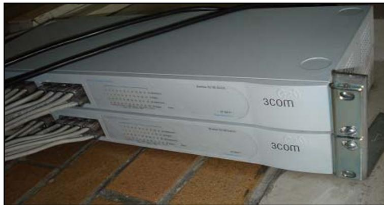
FOTOS 4.36. CONEXIÓN EN CASCADA DE SWITCH PARA EL LABORATORIO 2
