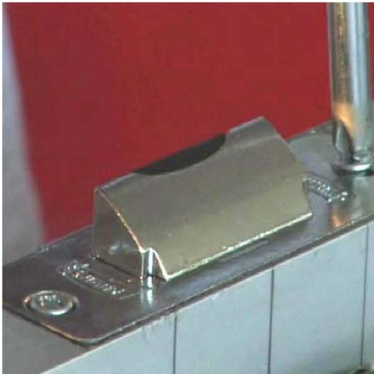
Se introduce el mecanismo en el perfil y se atornilla a las placas de sujeción sin apretar totalmente los tornillos.
