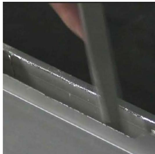
Después de realizar el barreno frontal se liman los bordes hasta que la cerradura entre en el perfil holgadamente.
