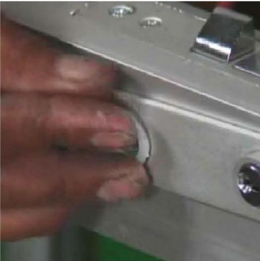
Se coloca el buje plástico a presión en el orificio de las manijas.
