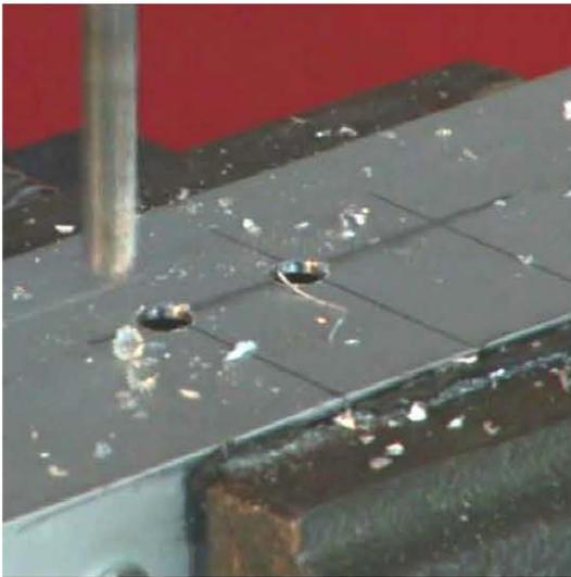
Al terminar el barrenado frontal se realizan los barrenos laterales que recibirán las manijas de la cerradura.
