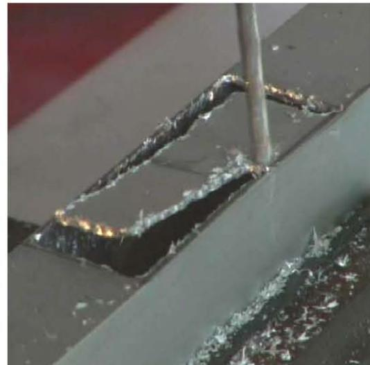
Se realizan las perforaciones sucesivamente hasta terminar un barreno rectangular donde quepa el mecanismo. Y dos barrenos donde se colocarán las placas de sujeción.
