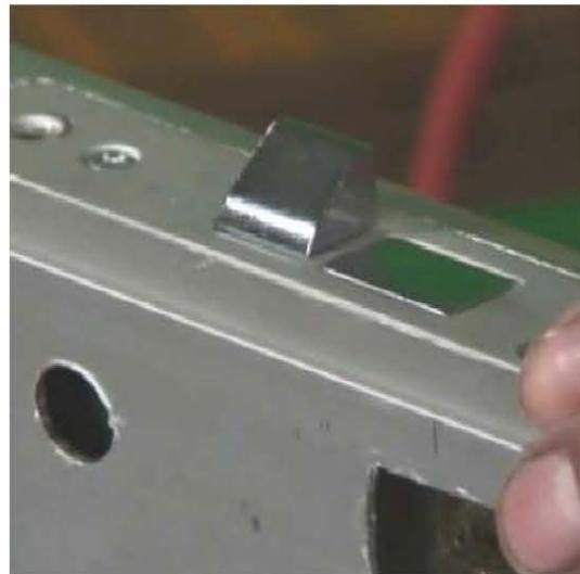
Se colocan las placas de sujeción y posteriormente se introduce el mecanismo y se atornilla levemente sin apretar.
