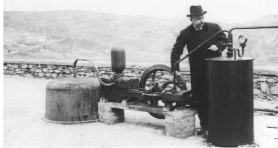
Figura 1.1 Primer motor usado para generación eléctrica con vapor geotérmico, y su inventor, Piero Ginori Conti [IGA, 2003]
