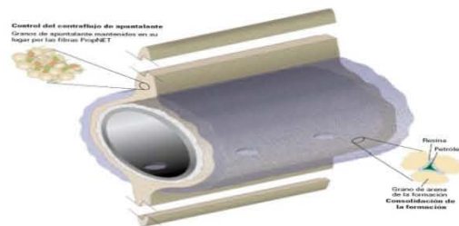
Figura 2.13 Fracturamiento hidráulico sin cedazos para el control de la producción de arena. 14
