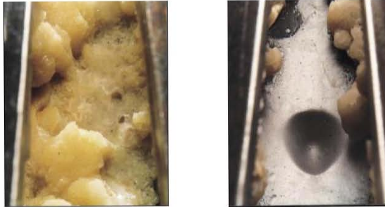
Figura 2.11 Eliminación de incrustaciones de carbonato de calcio con chorros de agua y con agua abrasivo (con arena abrasiva) 9
