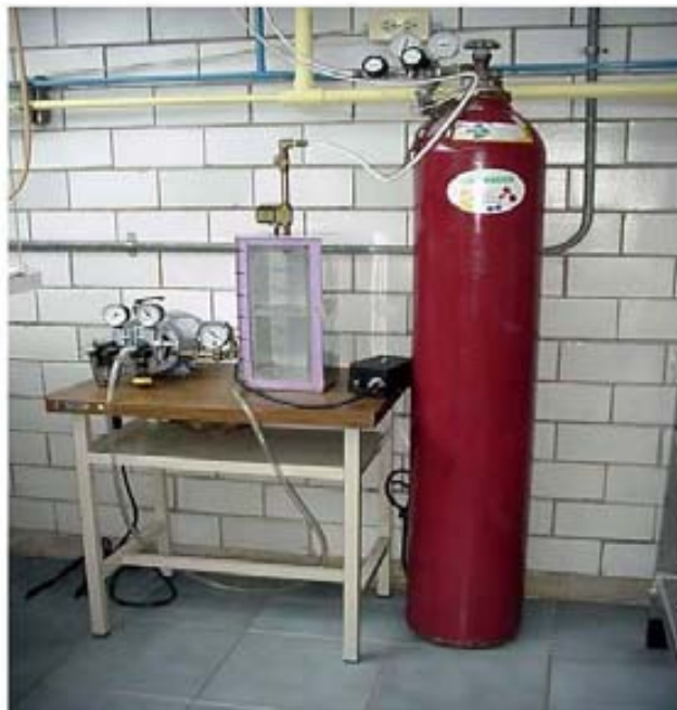
Fig. 3.3.2.1 Conjunto de cámara de bombardeo y el tanque de Helio.
