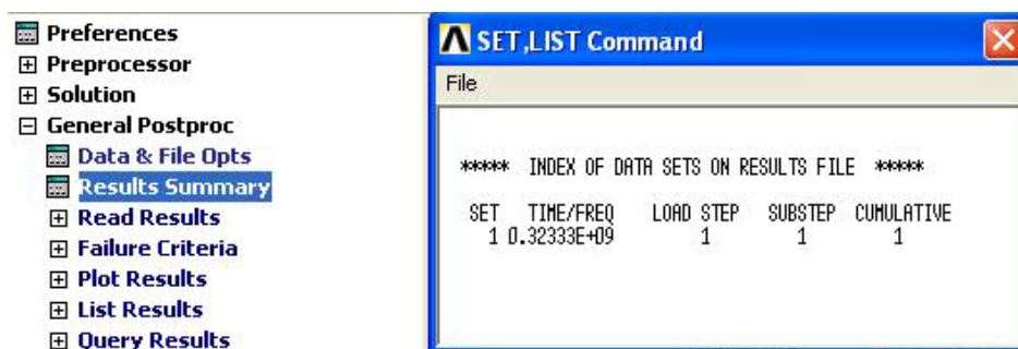
Figura 4.32. Frecuencia de resonancia resultado de la simulación.
