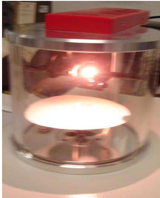
Figura 2.8 Equipo para recubrir las muestras con carbón
