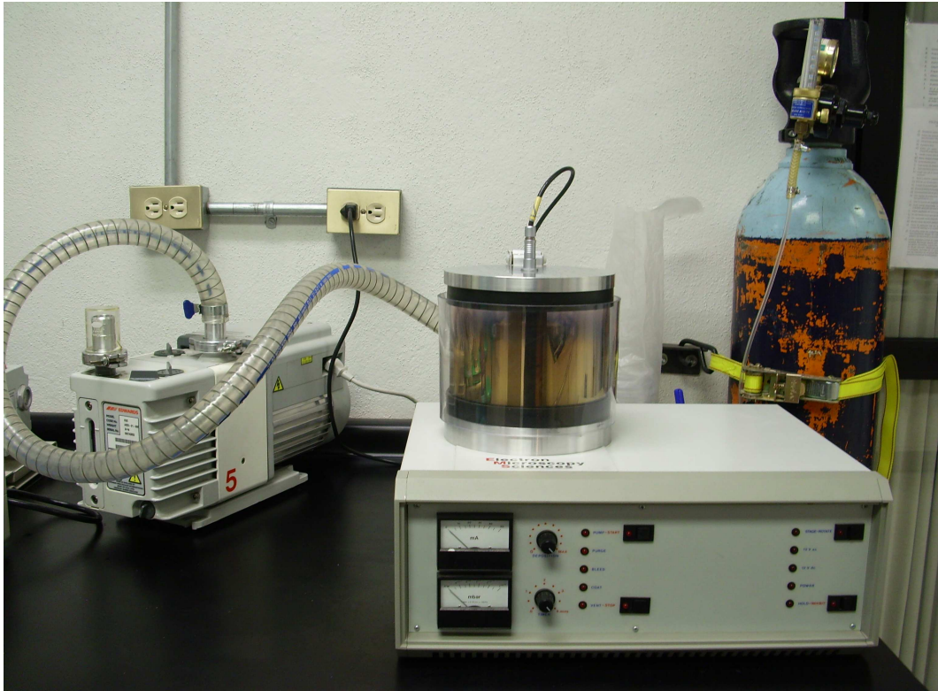
Figura 2.7 Equipo para recubrir las muestras con oro
