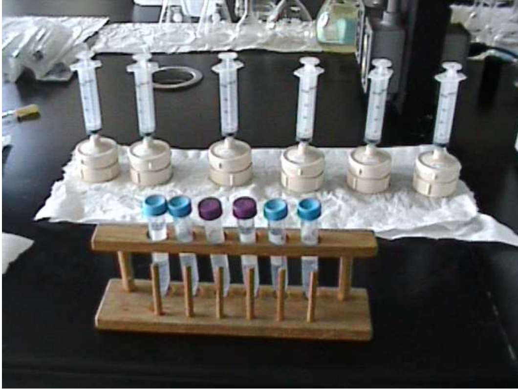
Figura 2.14 Filtración de todas las muestras recolectadas a los 60 minutos
