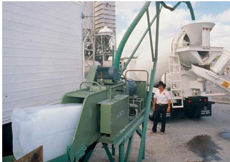
Imagen 5.2 Equipo para triturar el hielo e introducirlo como parte de agua de mezclado
