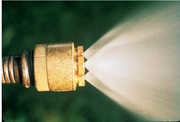
Imagen 4.1 Chiflón para humedecer y enfriar los agregados
