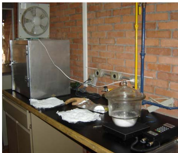
Figura 4.23 Fotografía del equipo para deshidratar el \text{LiNO}_3 .
