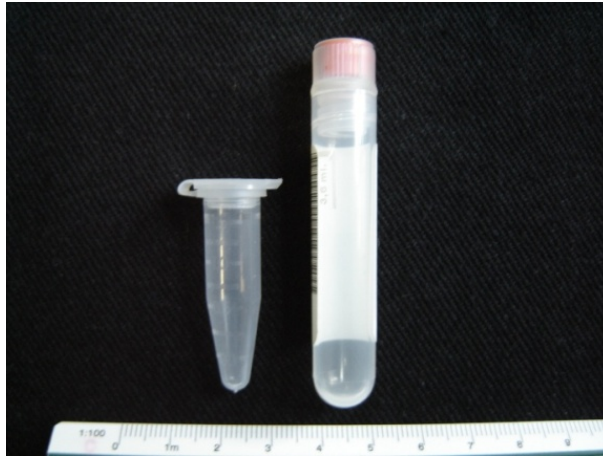
Figura 4.44. Tubos de ensayo utilizados para las pruebas de magnificación e inversión de las imágenes obtenidas con el colimador pinhole
