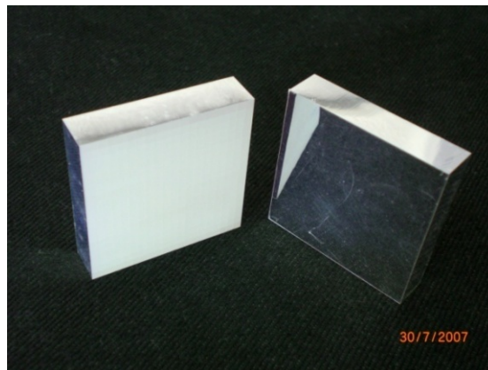
Figura 3.2. Fotografía de los dos arreglos de cristales LYSO:Ce empleados en el microPET
