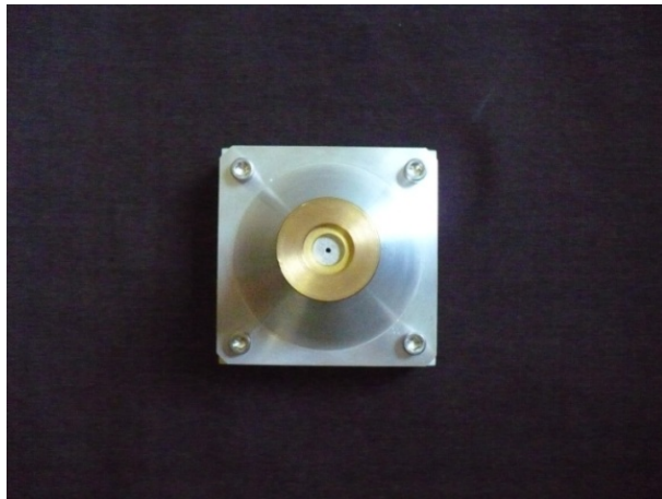
Figura 3.40. Colimador pinhole construido para el sistema microSPECT
