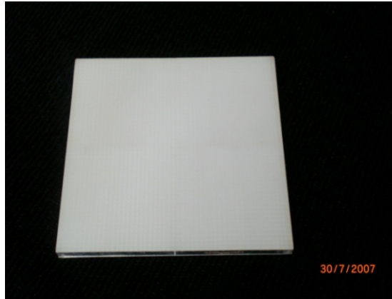
Figura 3.7. Fotografía del arreglo de CsI:Tl de 50×50 elementos utilizado para la adquisición de imágenes en modo microSPECT
