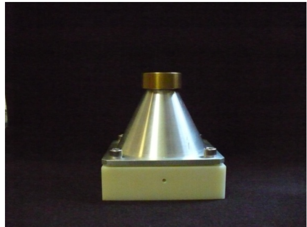
Figura 3.40. Colimador pinhole construido para el sistema microSPECT
