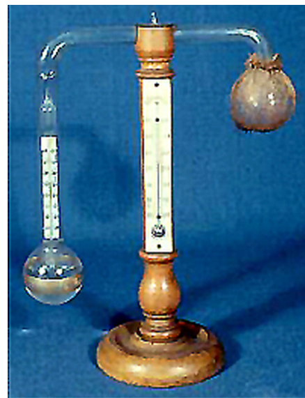
Daniel fue el primero en poder medir el punto de rocío a partir del psicrómetro que da la diferencia de humedad entre el bulbo húmedo y el bulbo seco.
