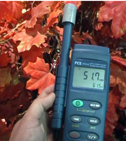
Los hygrometros son los aparatos que sirven para medir la cantidad de humedad existente en la atmósfera. Los hay digitales y mecánicos. El tipo de humedad que se mide en meteorología es la humedad relativa
