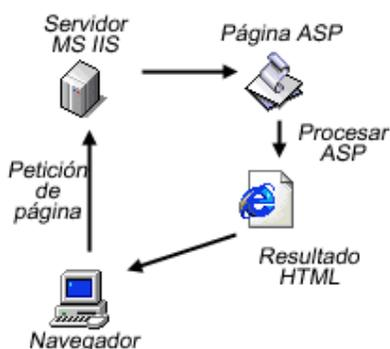
Fig 2.-Funcionamiento de una pagina en ASP
