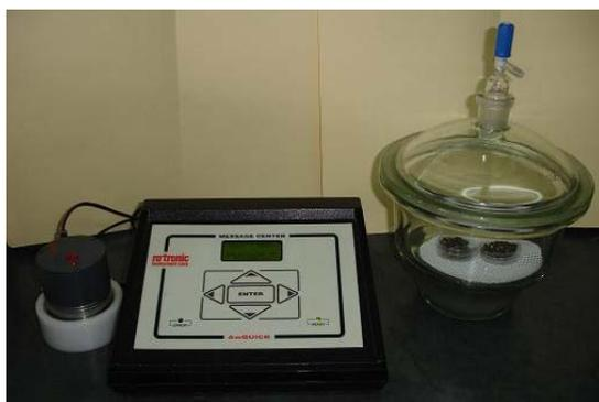
**Figura 12.** Izquierda: Equipo AwQuick A2101 para determinación de actividad de agua de muestras sólidas. Derecha: Sistema utilizado para el pre-equilibrio de muestras con disoluciones salinas sobresaturadas.
