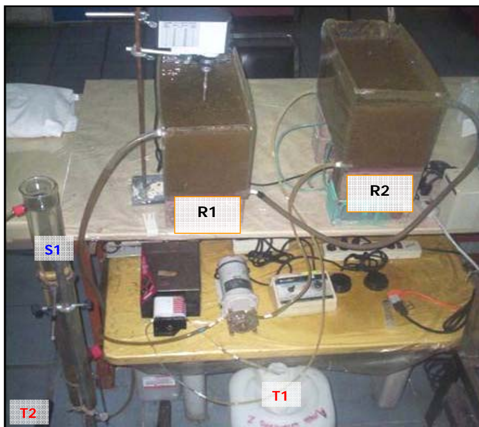
Figura 3.6. Fotografía de la tercera configuración de lodos activados
