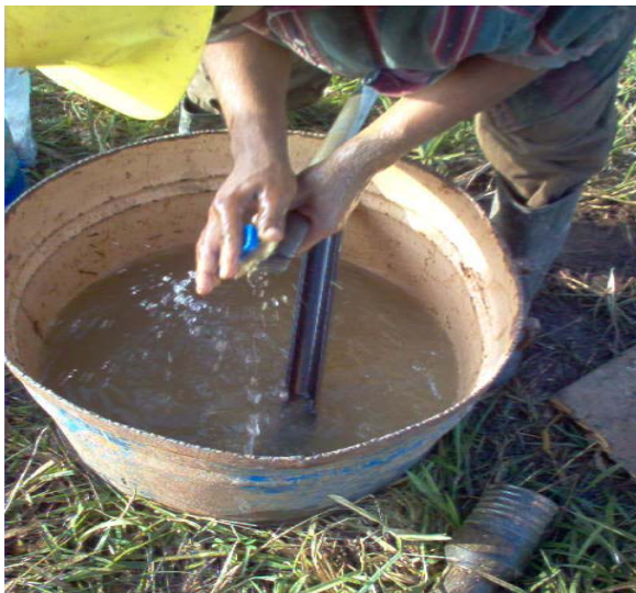
FOTO 7.- LAVADO Y ARMADO DEL TUBO PARTIDO
