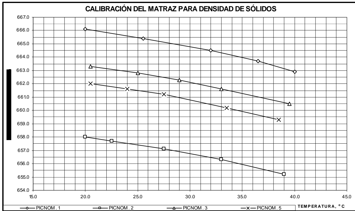
Figura III.2 Esquema de la curva de calibración del matraz. Fuente: Elaboración propia con datos obtenidos del laboratorio de mecánica de suelos.
