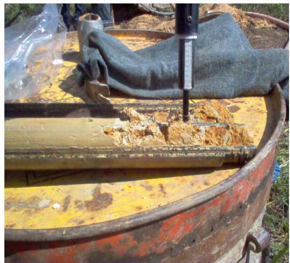
FOTO 8.- PENETRÓMETRO DE BOLSILLO EN MUESTRA DEL SPT.
