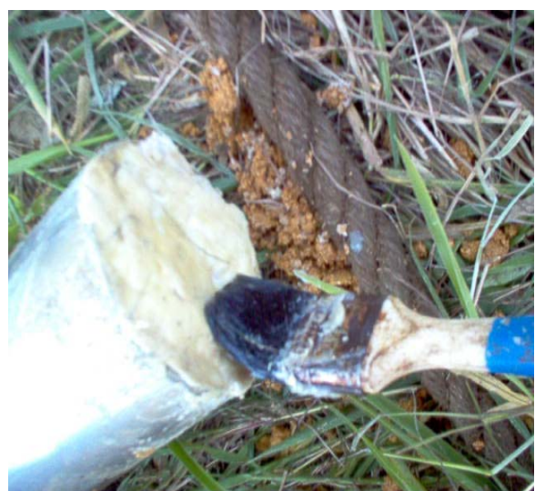
FOTO 16.- RECUBRIMIENTO DE LAS MUESTRAS INALTERADAS
