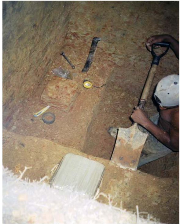
FOTO 18.- LABRADO DE MUESTRAS INALTERADAS (MUESTRAS CUBICAS) DEL PCA N° 2
