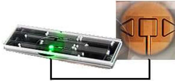
Figura 1.1: Microdispositivo desarrollado por el Instituto de Bioinformática de Virginia para rastrear indicadores moleculares de un gran número de biopartículas como células cancerígenas. Este dispositivo está integrado por: una bomba, una válvula, una columna de separación y una interfase de detección dentro en un microcircuito de vidrio de  $7.5 \times 2.5 \text{ cm}$ . Es capaz de realizar tareas que generalmente requieren equipo instrumental de algunos  $m^2$  [3].
