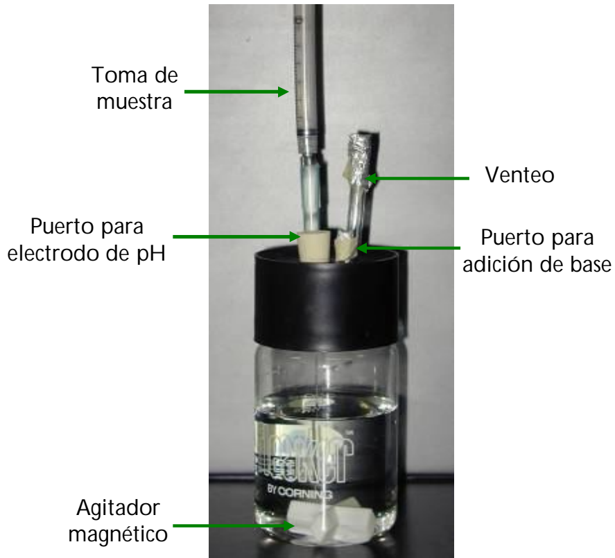
Figura 35. Modo de preparar los mini-fermentadores para su esterilización.
