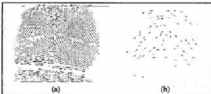
Figura 24. (a) Imagen después de la simplificación y eliminación de imperfecciones. (b) Patrón de minutiaes después del proceso de eliminación de conjuntos.
