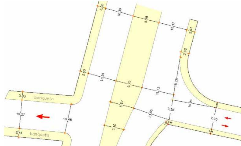
**Imagen 2.** Camellón de Av. Canal de Tezontle, empieza con un ancho de 7.10m creciendo a 9.70m para después disminuir a 9.58m. Arroyo vehicular 10.40m. Hacia Av. Río la Antigua arroyo vehicular de 7.90m (ultimo imp pues es circulación hacia el terreno).
