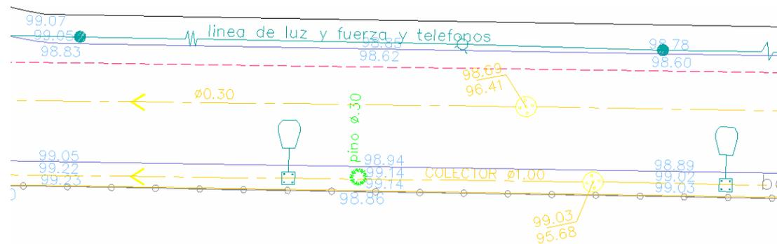
**IMAGEN 9** Red de agua potable (en rosa). Red de drenaje y sentido, Ø30. colector Ø 1.00 Postes arbotantes. Postes y líneas de luz y fuerza y teléfonos.
