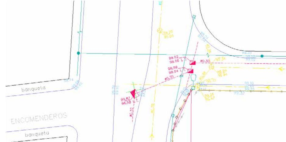
**IMAGEN 5.** Red de agua potable (en rosa) Ø 0.30. Red de drenaje sentido, Ø38. Poste arbotante. poste y línea de teléfonos.
