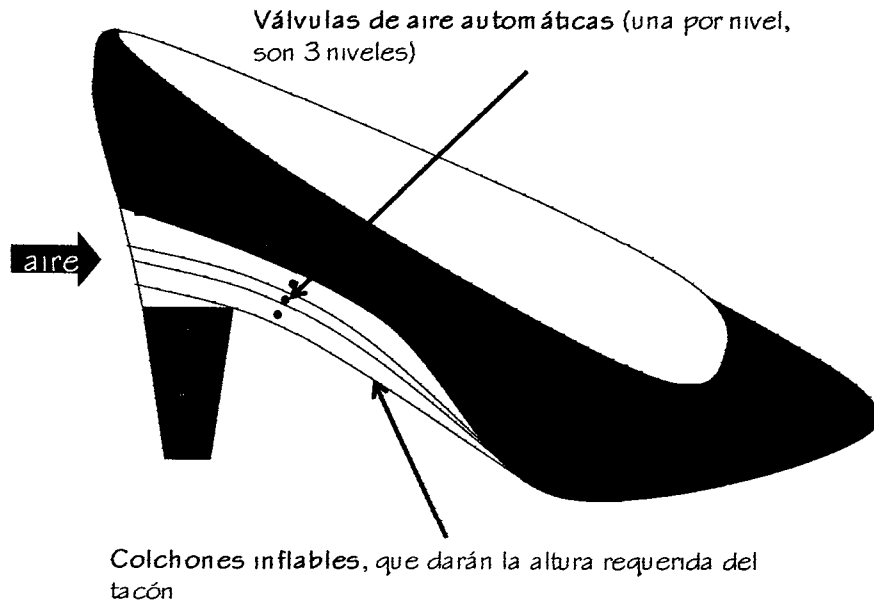
Figura 6.1.7.1 Zapatilla de altura ajustable por medio de un sistema de válvulas de aire.
