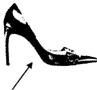
Figura 7.2 Área donde se encuentra el problema de generación de arrugas.
