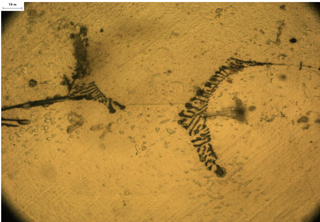
Foto 4. Microconstituyente eutéctico muestra "D" a 1000x.
