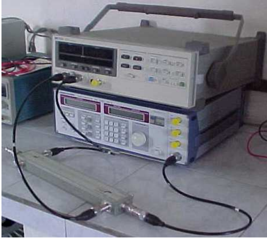
Figura 6.3: Instrumentación empleada durante las pruebas de longitud eléctrica aplicando la técnica de reflexión.
