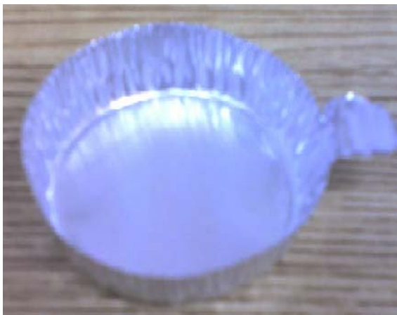
Fig. 10 Charola de aluminio para realizar La prueba de PE
